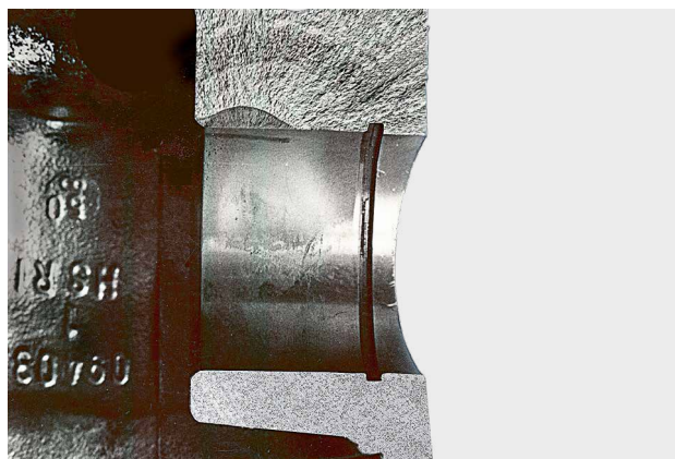
Рис. 3: Поперечное сечение бобышки поршня
